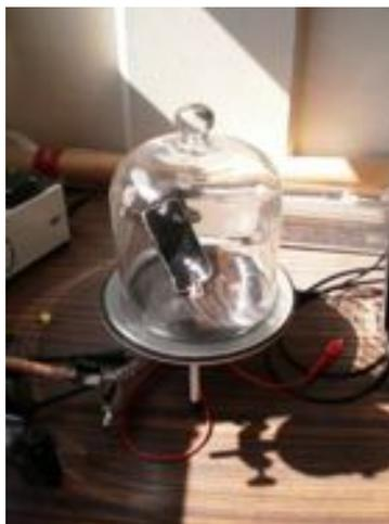
important de noter que dans cette expérience, l'impossibilité pour le son de se propager n'est pas réellement due au vide. Les pompes que l'on utilise ne sont pas suffisamment efficaces pour créer un vide total sous la cloche mais abaissent tangiblement la pression. La différence de pression entre les milieux extérieur et intérieur conduit à un phénomène de réflexion total de l'onde sonore.
