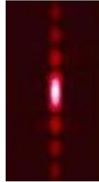
On mesure la largeur  $d$  de la tache centrale pour chaque fil. La formule qui s'applique est la suivante :
